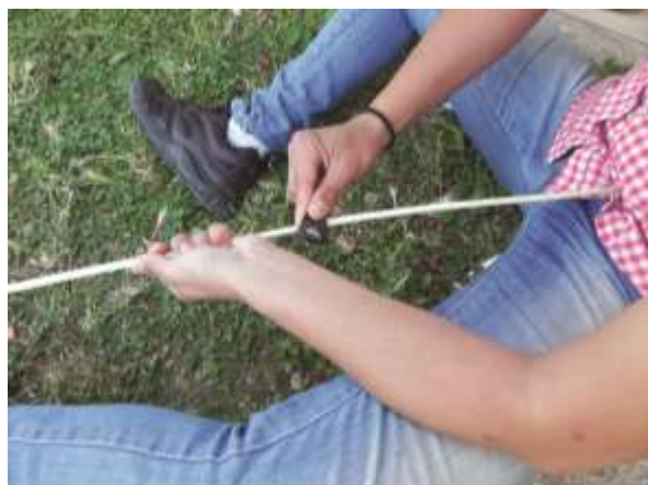
fig. 18 : Rabotage, affinage et polissage d'un fût
