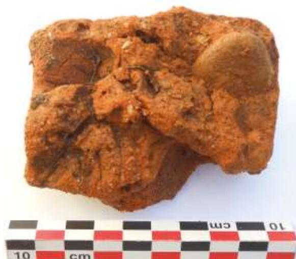
fig. 23 : Grosses inclusions dans l'argile de construction
